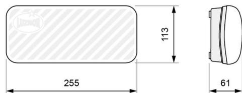
Montaje empotrado (corte: 265 x 120 mm)
